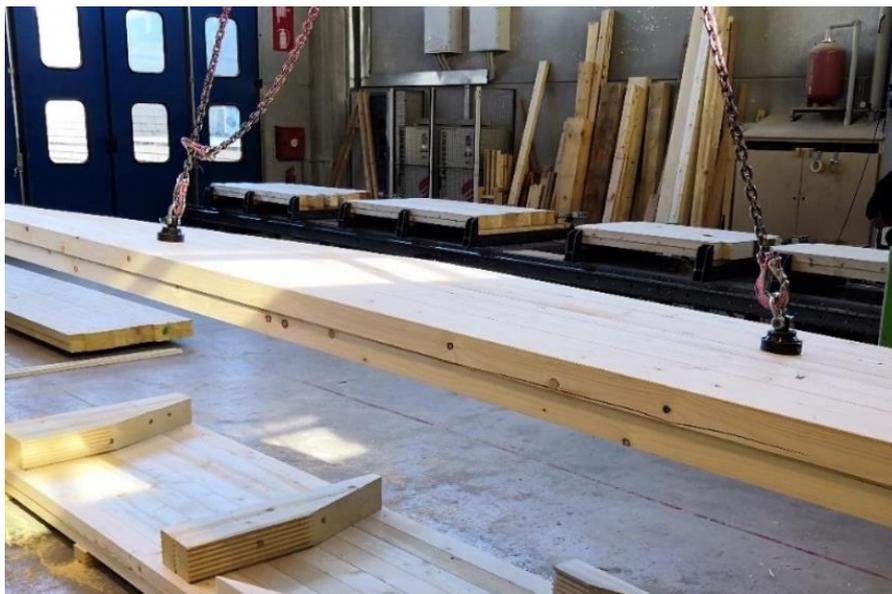
Figura 11: I singoli solai in legno massello possono essere sollevati con il cosiddetto "pick" (Sihga) o altri ancoraggi di sollevamento.
