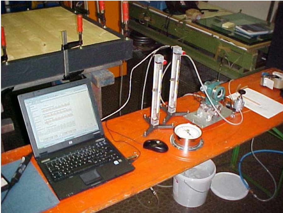
Bild 3 Messeinrichtung mit Durchfluss- und Druckmesseinheit.
