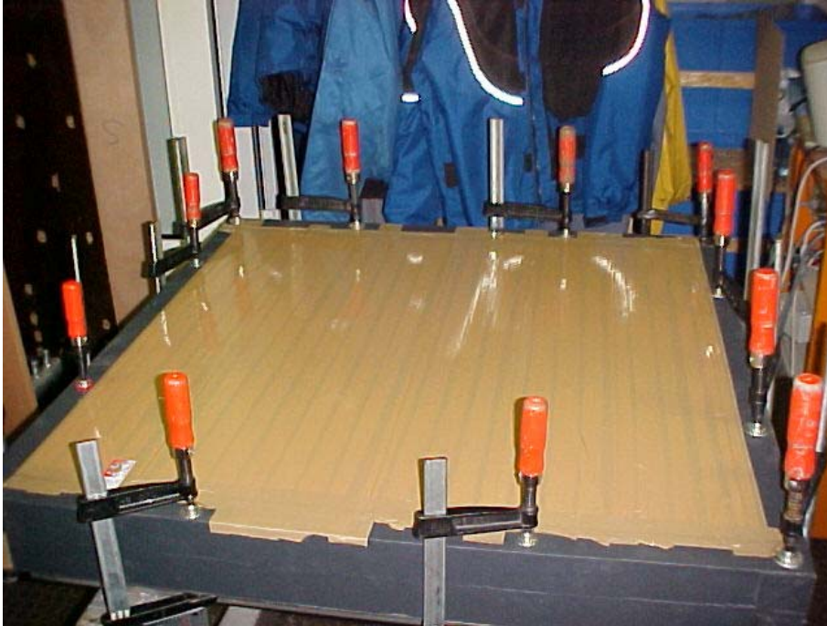
Bild 1 Probekörperaufbau Nullmessung (Element vollflächig abgeklebt)
